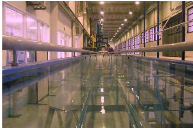
Figura 12: Canal d'onatge del Laboratori d'Enginyeria Marítima, al campus de la Universitat Politècnica de Catalunya
